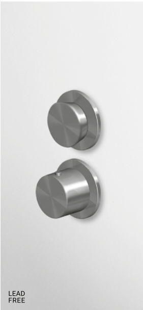
DOCCIA Termostatico incasso da 3/4", con rubinetto d'arresto. Installazione possibile sia in verticale che in orizzontale. 3/4" built-in thermostatic shower mixer with stop valve. Both vertical and horizontal installation possible.
