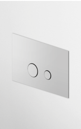
PLACCA PER CASSETTE DI SCARICO Placca di comando in acciaio inox, attacco magnetico, senza fissaggi a vista. Compatibile con Geberit Sigma 8 e Sigma 12. Incasso minimo della cassetta Geberit: 25 mm. Toilet flush plate with stainless steel plate, magnetic connection, no fixing in sight. Suitable for use with Geberit Sigma 8 and Sigma 12. Minimum gap required for the Geberit box: 25 mm.
