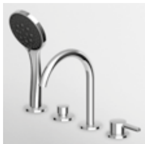
BORDO-VASCA Miscelatore monocomando 4 fori, bocca girevole o bloccabile in fase di installazione, doccia estraibile Z94746, flessibile da 1500 mm. 4 hole bath tub single lever mixer, swivel spout or lockable during installation, pull out shower Z94746, 1500 mm flexible hose.
