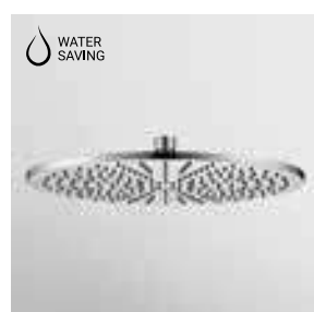
SOFFIONE Ø 400 In ottone, a getto fisso con sistema anticalcare, spessore 8 mm. Ispezionabile.
