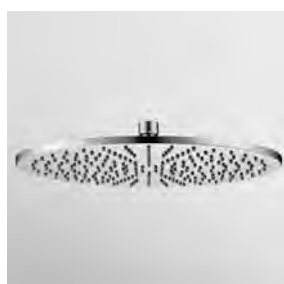
SOFFIONE In ottone, a getto fisso con sistema anticalcare, Ø 400 mm e spessore 8 mm. Ispezionabile.
