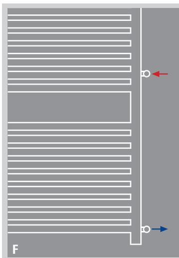
Allacciamento laterale destro oppure sinistro **a richiesta**, ideale per sostituire un vecchio radiatore.
