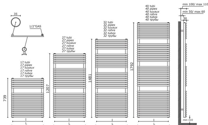
Interasse dal centro foro al muro min. 67 / max 77 mm.
