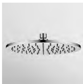
SOFFIONE In ottone, a getto fisso con sistema anticalcare, Ø 300 mm e spessore 8 mm. Ispezionabile.
