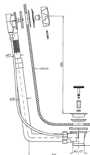
Con sifone snodato a saldare per tubi Ø 40-50 mm.
